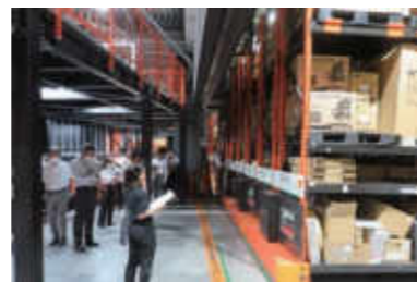
電動式移動パレットラック
