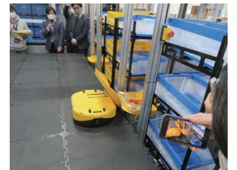
ピッキング商品をt-sort3DがAGV自動仕分けリレーを自動化と共に無理なく実現したのが今回のコラボレーションと言えそうです。
