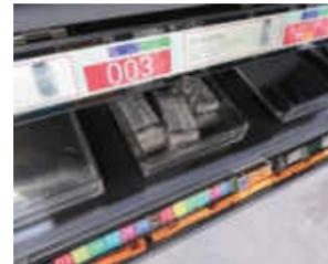
●伊東電機の注目展示はMDR式のMail-Sorterです。コロナ禍で増加したポストイン配送のように薄型化が進む梱包形態に対応したソーティングシステムで、従来センサが横から物を捉えていたのに対し、ローラの間隔を通して下側からセンシングする伊東電機オリジナルラインセンサを採用することで、従来は困難だった超薄物の搬送を実現しました。併せて直角移載装置のF-RATを高速仕様で改良することで、1時間当たり3,000という仕分け能力を発揮しています。
