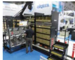
●オムニシダのブースでは、オムニデパレシステム(ODS)に注目です。これはパレットからカゴ車へのデパレタイズをする装置で、今回はシステム全体の中でもロボット部を中心に展示、安川電機製ロボットに同社の自社開発ハンドを装着し、12kg以上のドリンクケース等の荷物を上面吸着の後に下から支える動きで落下の確率を軽減しています。また今回は逆のフロー、カゴ車からパレットへのパレタイズのデモを通じて、デパレ&パレの双方向システムとしてもアピールしました。
