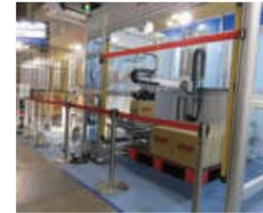
●**住友重機械搬送システム**は、同社のディープストレージ式高密度自動倉庫のマジックラックを中心に、自動搬送機器のAGVとAGFをリンクさせた展示が注目です。マジックラックの導入効果である保管効率向上によって生み出されたスペースに自動搬送機器を配置することで、自動保管から自動搬送までを含めた物流現場全体の省人化・省力化を実現するソリューションです。住友ナコフォークリフト社との共同開発になるAGFは参考出品ながら2023年に製品リリース予定です。
