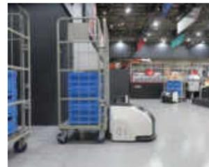
●オークラ輸送機では、EC拡大等々で今、最も労働力不足に直面している物流倉庫内ピッキングの負担を自動化によって解消する提案として、独自のGTPソリューションを展示しました。これは棚搬送ロボットとピッキングステーションをシステムで連携し、入庫と出庫を自動化するシステムです。また、ビジョンロボットによるオリコンのパレタイズ・デパレタイズや新開発のカートラック牽引用ロボットも実演し、トータルシステムを訴求しました。
