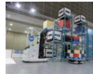
●**村田機械**ブースの注目展示は、ロボット台車のBOTが保管+搬送+仕分け+ピッキングのすべてを行う最新鋭の統合型G2P (Goods To Person) ソリューションであるALPHABOT (アルファボット) です。同社はアルペンの巨大センター導入実績を足掛かりに日本市場での拡大につなげる考えで、G2Pロボット倉庫と呼んでいます。今後は床面積あたりの総保管量、膨大なSKUの取り扱いに対応できる点を同機のアドバンテージとしてEC、小売系等を視野に拡大展開を進める方針です。
