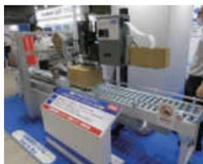
●**レンゴー**は「最適包装で通販・物流課題を解決」をコンセプトに、環境負荷の低減、省人化の提案、通販イノベーションの3つのテーマで出展。ホットメルトやヒートシール、エア緩衝材不使用のオール紙製緩衝封筒自動包装機レンクッションパックと、ポストインサイズ包装のSmartPostinをお披露目。ECフルオートパッケージングラインではMujinとのコラボで製函から商品の箱詰め、緩衝材投入、高さ可変による封函までの省人化を提案しました。
