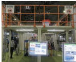
●**三機工業**ブースの展示テーマは、仕分け革命です。注目の展示デモは縦型搬送仕分けシステムのReverse Sorter (リバースソータ)、従来の平面で搬送するクロスベルトソータを縦型に置き換えた構造により、約40%もの省スペースでの自動仕分けを実現、これにソーティングロボットシステム Melis Bianca を組み合わせてシステム化しており、いずれも同社の自社開発ソリューションです。比較的コンパクトなB2C通販等をメインターゲットに想定しています。
