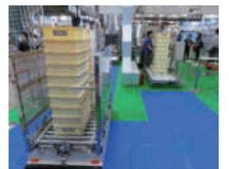
●**サトー**のブースは、自動化／デジタル化で物流DXを推進、のコンセプトのもと、送り状等各種ラベル貼り付けの自動化製品を中心に展示しました。注目は、画像認識+ラベル自動印字貼付機のS-ROBO Proで、(最大)1秒間に1枚のラベル貼付能力を持つ高速貼り付け装置です。商品をコンベヤへ置くだけで商品の向きや形を3D計測し、指定された位置へ正確にラベルを貼り付けます。従来困難であったシュリンク食品パック等への賞味期限ラベル貼り付けの自動化が可能です。
